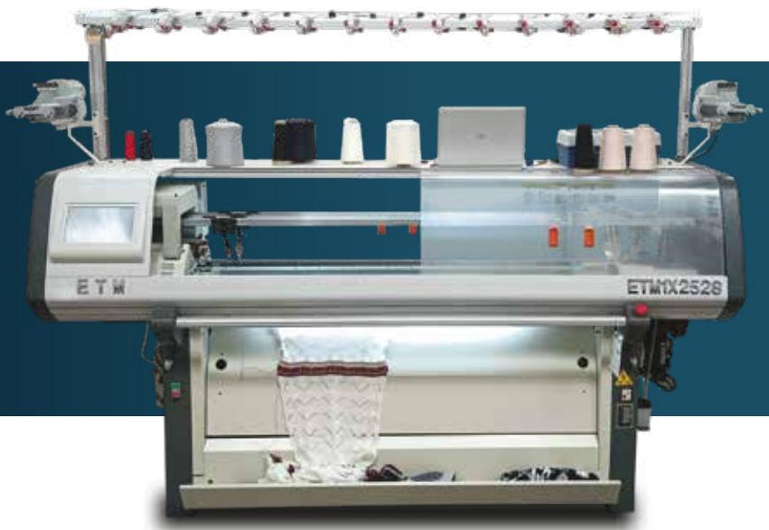
Máquina de tejer de carro único con sistema de retorno de carro por 1 vía, calidad estable, múltiples funciones, mejora la eficiencia en aproximadamente un 20%. Con la tecnología de control dinámico, una misma línea puede lograr efectos de diferente densidad. Es adecuado para suéteres tejidos, bufandas, gorros y accesorios de ropa elaborados con seda, seda hilada, hilo sintético, lana, fibras acrílicas, mezclas, hilo y otros materiales..
