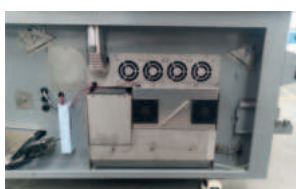
PURIFICADOR DE AIRE PARA EVITAR EMISIONES DE POLIAMIDA
