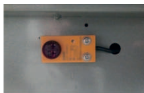
SENSOR ÓPTICO PARA PRESENCIA DE MATERIAL
