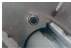
SENSOR ÓPTICO PARA PRESENCIA DE POLIAMIDA
