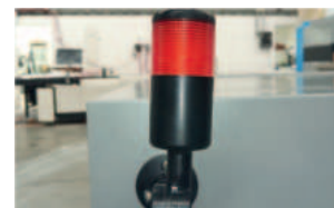
LUZ LED INDICADORA DE AUSENCIA DE POLIAMIDA
