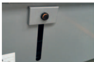
SENSOR ÓPTICO PARA DETECCIÓN DE MATERIAL
