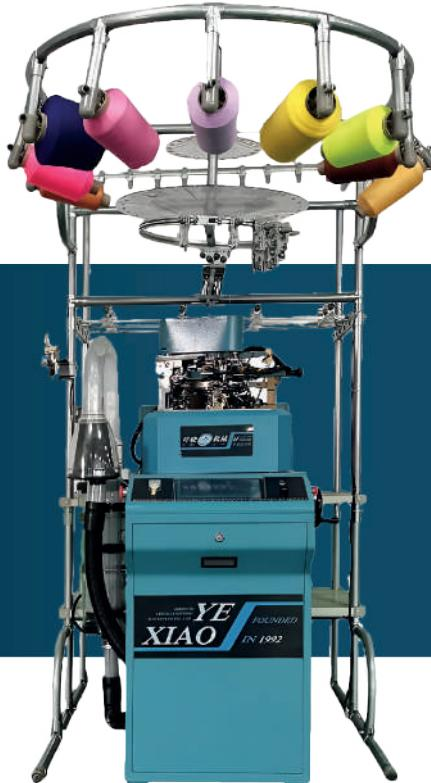
Máquina de tejer de doble alimentador, diseñada para fabricar calcetines de felpa o lisos con patrones jacquard de hasta 6 colores en una línea. Incorpora funciones similares al modelo de un alimentador, pero con mayor versatilidad para diseños complejos. Velocidad máxima de 320 rpm.
