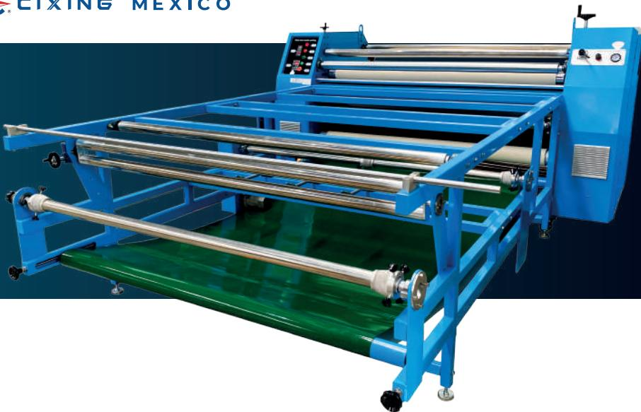
La calandra de aceite CY-003 utiliza un cilindro teflonado sin corte, 100% de aceite y resistencias, fabricado con torno de alta precisión. Equipada con sistema neumático para presión uniforme y sublimado sin pérdida de color. Su panel industrial permite ajustar velocidad y temperatura con precisión, alcanzando hasta 250°C. Gracias al cilindro teflonado sin corte, el calor se distribuye de forma uniforme, asegurando una transferencia impecable.
