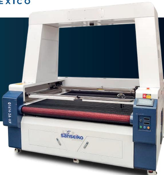
La Cortadora Láser HQ-1610-VAF con cámara de visión inteligente ofrece cortes precisos y automáticos, optimizando material y tiempos de producción.
