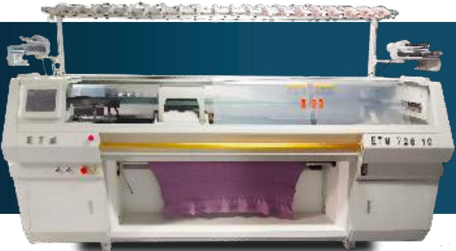
Máquina de tejer de un carro único con tres sistemas, calidad estable, múltiples funciones, mejora la eficiencia en aproximadamente un 20%. Con la tecnología de control dinámico, una misma línea puede lograr efectos de diferente densidad. Es adecuado para suéteres tejidos, bufandas, gorros y accesorios de ropa elaborados con hilo sintético, lana, fibras acrílicas, mezclas y otros materiales.
