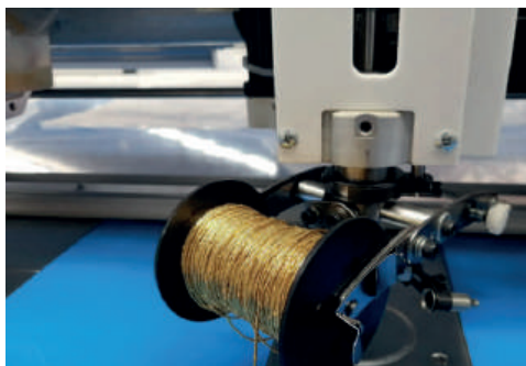
Dispositivo de cordón. Equipado con sistema de zigzag.
