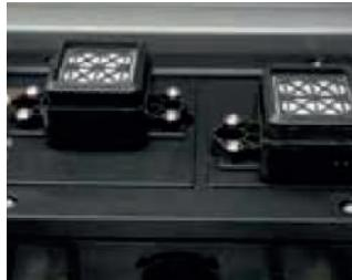
Sistema de plataforma, sistema de limpieza y protección de la boquilla.
