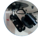
Apuntador láser para posicionar y no golpear los bastidores.
